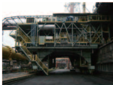
図1 コークス炉炭化室診断補修装置
