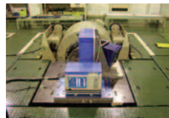
図1 計測器の耐振動試験
