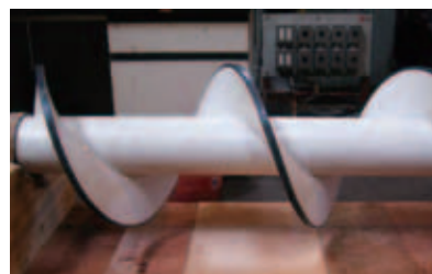
図4 セラミックス加工を施したスクリーフィーダー
