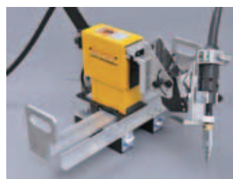
図4 溶接ロボット「石松」
